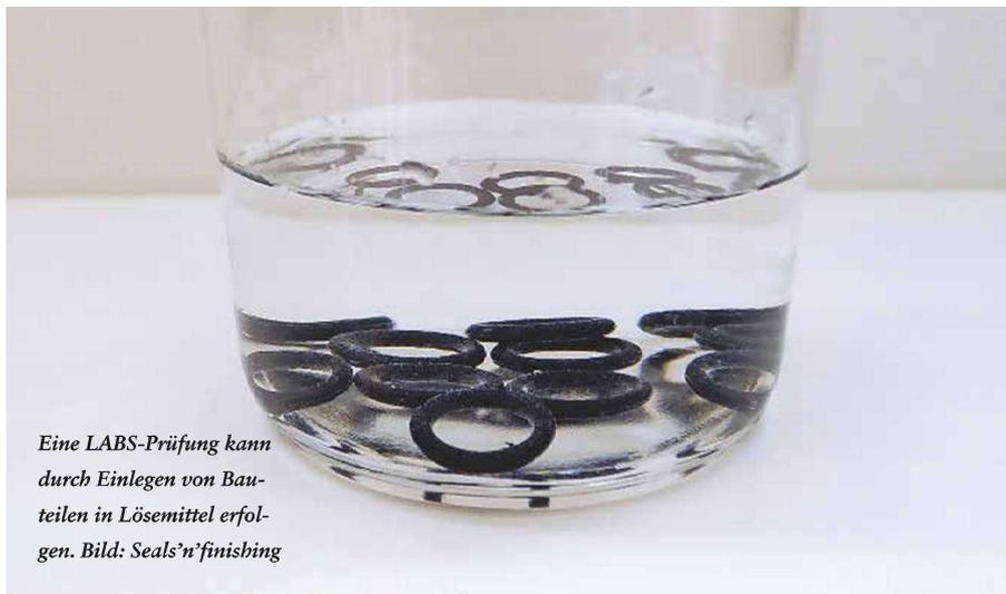
*Eine LABS-Prüfung kann durch Einlegen von Bauteilen in Lösemittel erfolgen. Bild: Seals'n'finishing*
