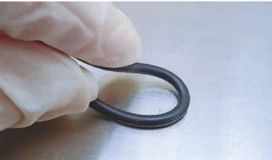
*Eine weitere Möglichkeit der LABS-Prüfung besteht im trockenen Abrieb.
