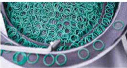
**Bild 2: Die automatische Montage – hier mit einem Vibrationswendelförderer – kann bei falsch gereinigten Dichtungen zu Problemen führen**
